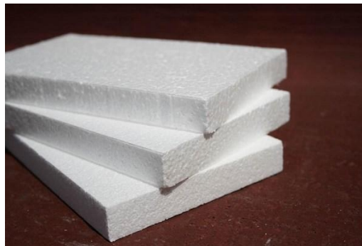
Рис. 2– Ізоляція з пенопласту
